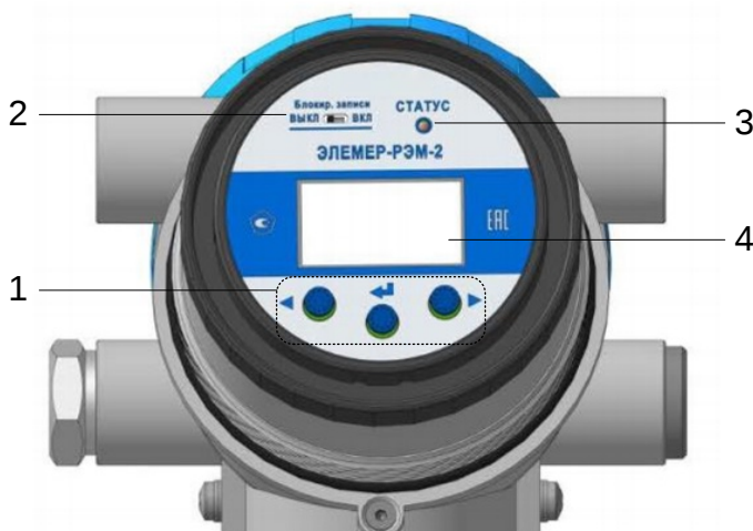
Рисунок 2.5 – Передняя панель ЭЛЕМЕР-РЭМ-2 с ВПР-02Н
